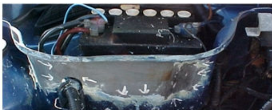
Ilustração 6 - Foto de perícia em um Gol que possui o VIN implantado na chapa do painel corta-fogo, à frente da bateria.
